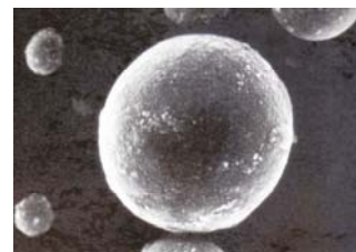
図17: 多層構造の化粧品素材粒子
